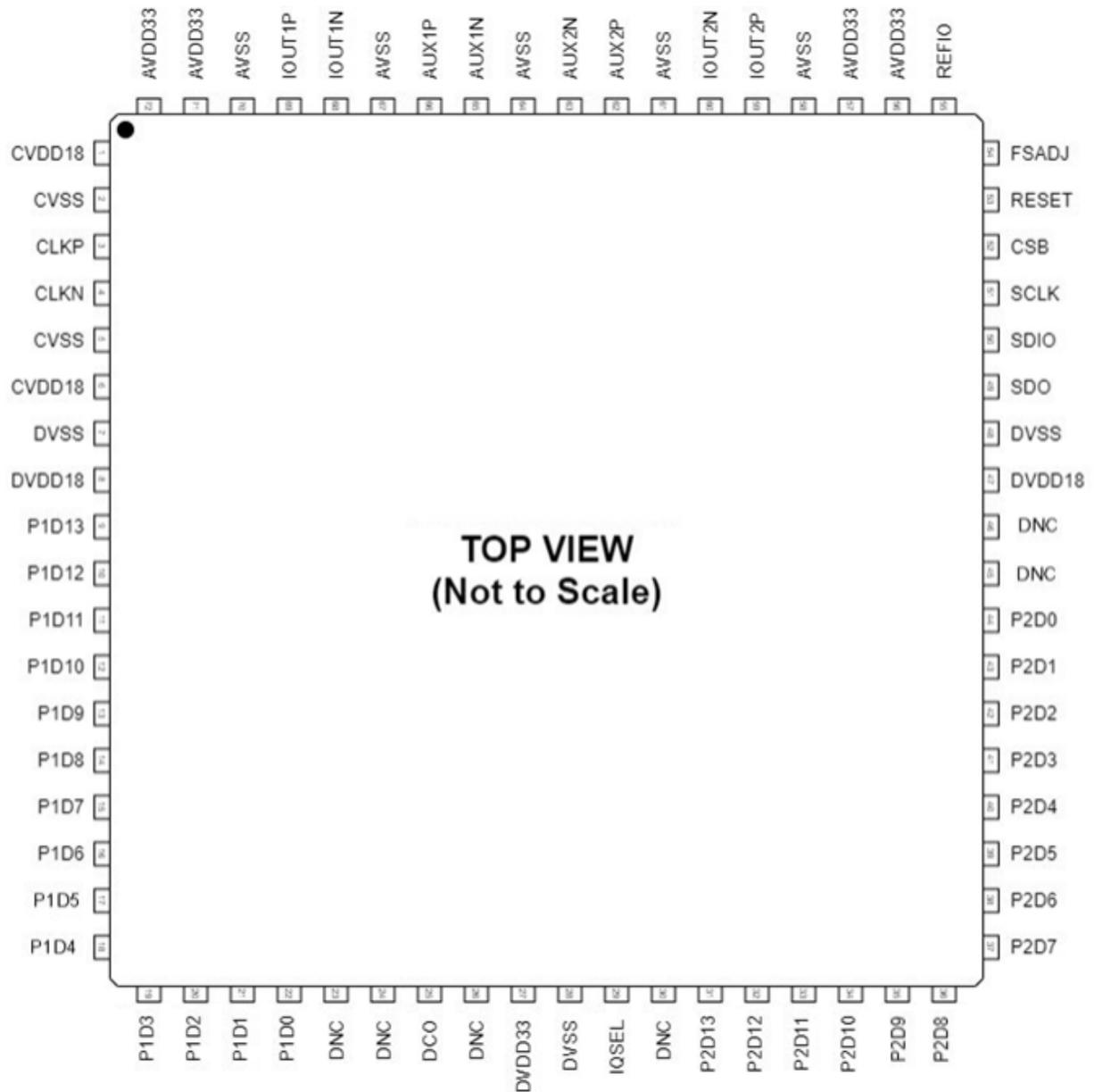
图 2 SC3341 引脚配置
