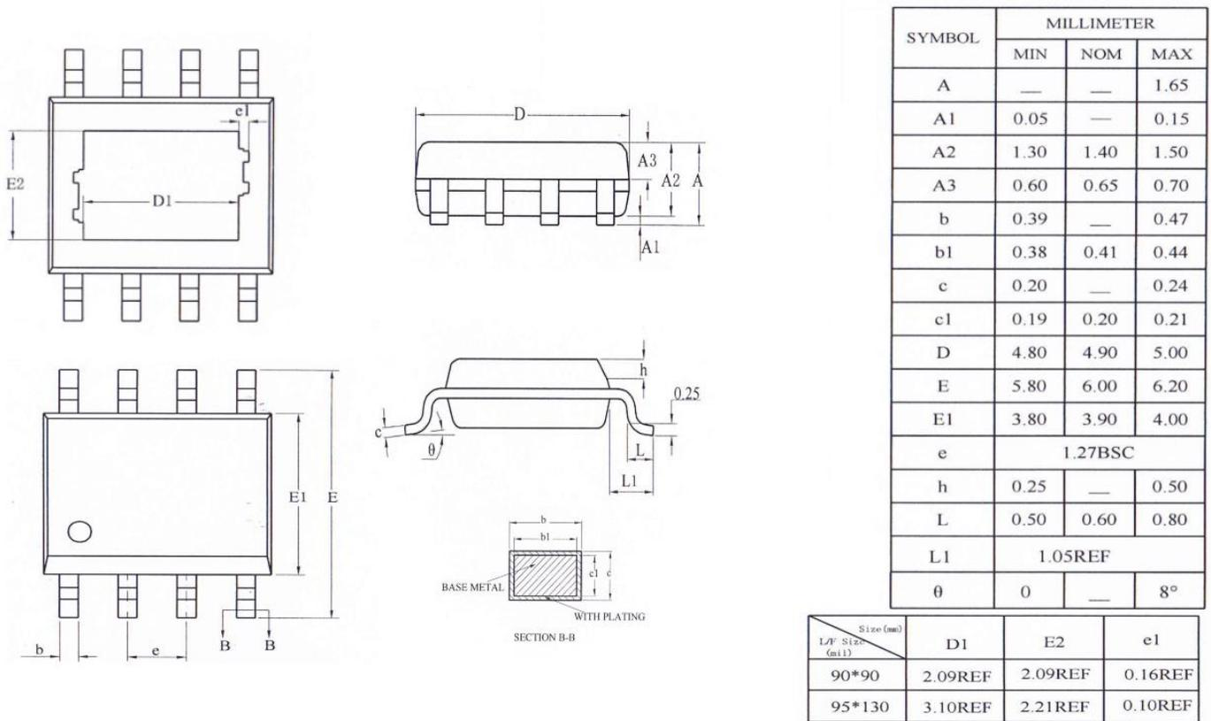
图 14 ESOP-8 封装尺寸图
