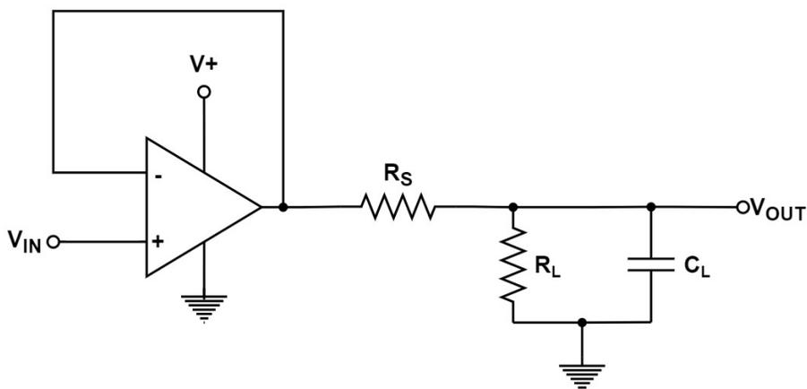
图 9 单位增益配置中的串联电阻器改进电容式负载驱动
