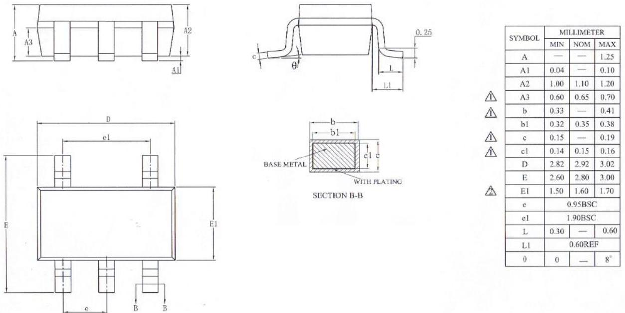
图 12 SOT-5 封装尺寸图
