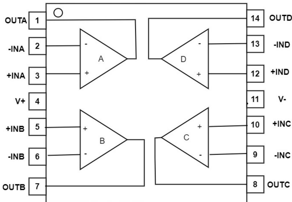
图 4 SC7518 管脚（焊盘）配置
