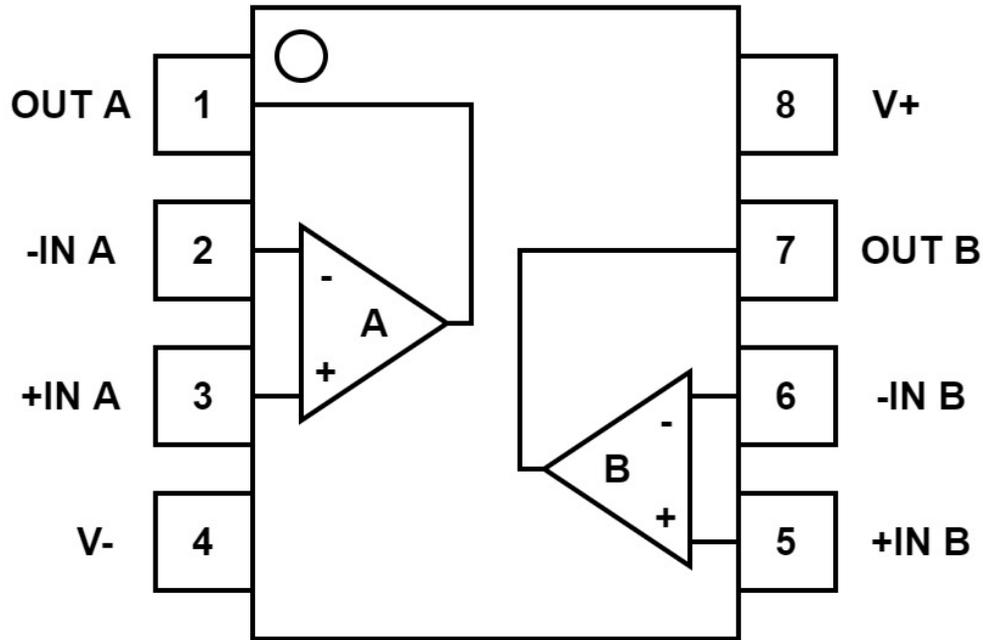
图 2 SC7510 管脚（焊盘）配置
