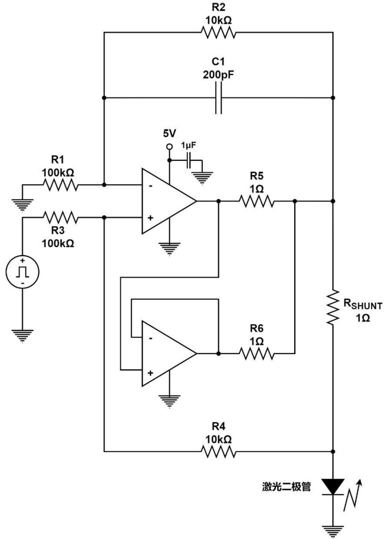
图 7 激光二极管驱动并行操作
