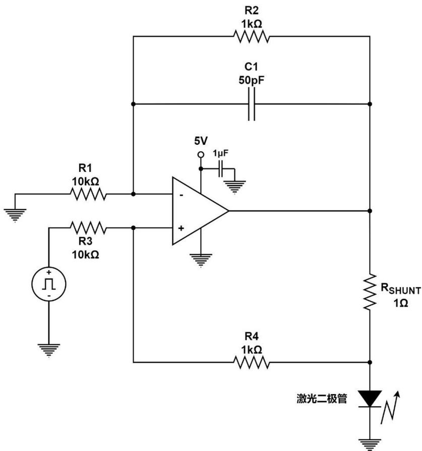
图 6 激光二极管驱动
