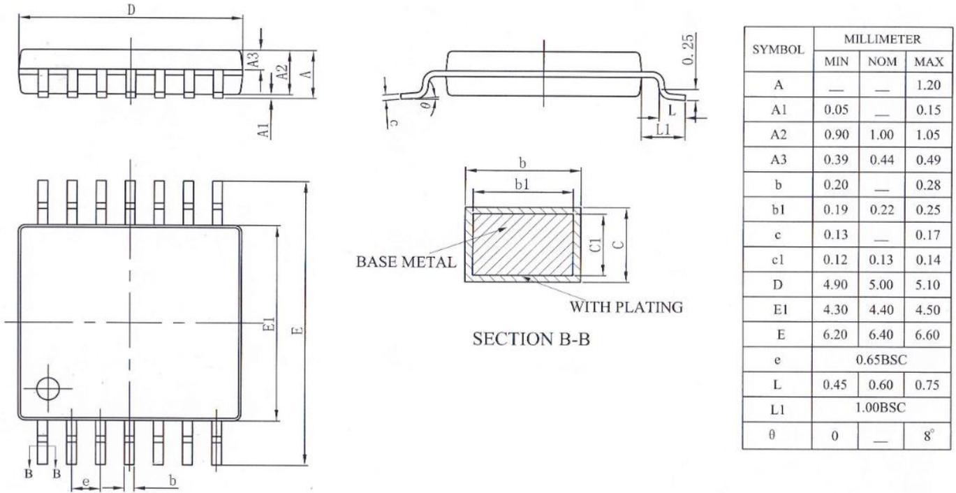
图 13 TSSOP-14 封装尺寸图
