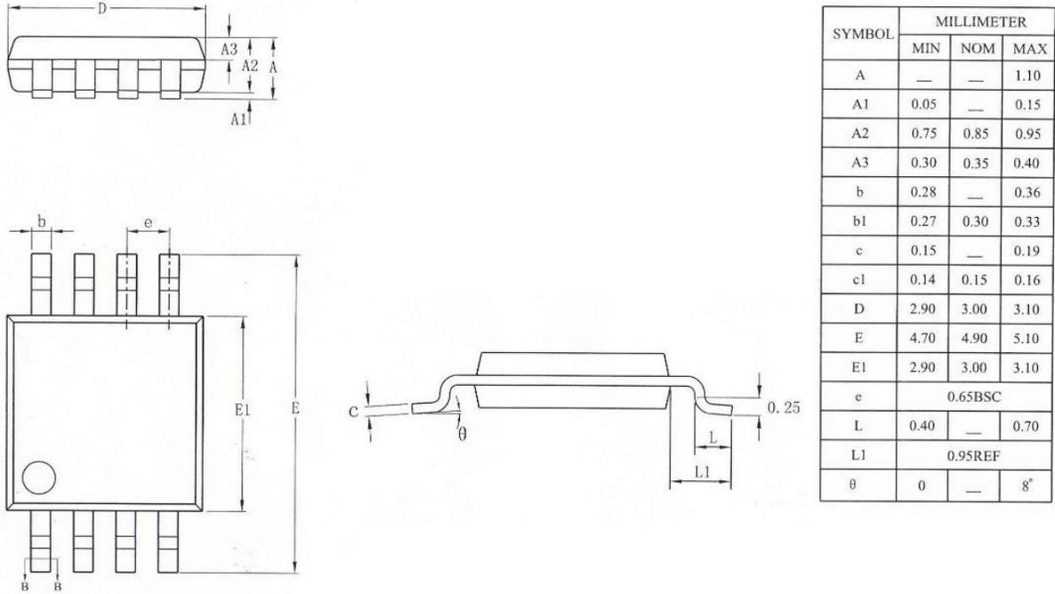
图 11 MSOP-8 封装尺寸图
