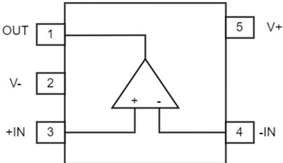
图 3 SC7517 管脚（焊盘）配置
